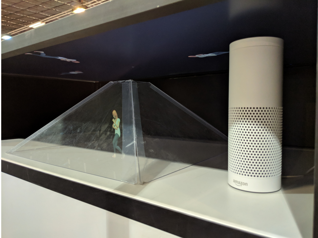
Abbildung 3.3: 1. Prototyp der Pyramide für das Hologramm
