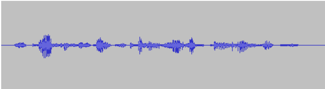
Abbildung 2.15: Veranschaulichung eines Sprachsignals. Text = "Sprachassistenten kommen immer öfter in Einsatz"
